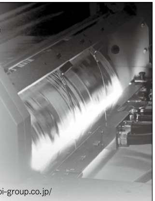
RYOBI 924 A全判高速オフセット4色印刷機
